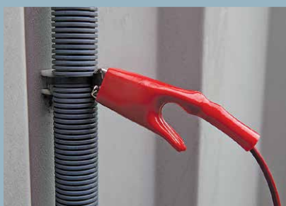
técnicas de seguimiento de cables de pequeño diámetro
