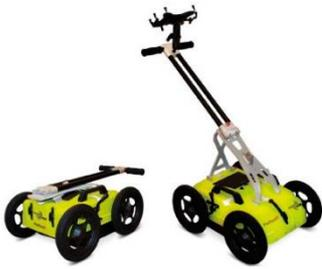
**Georadar** de última generación, para la obtención de imágenes radar del subsuelo marca Impulse Radar, Suecia, modelo PinPointR con antena doble frecuencia y amplio espectro de 400 MHz y 800 Mhz con nueva tecnología RTS (“real time sampling”). El equipo está compuesto de una unidad antena, electrónica y de control, una unidad operativa tipo Tablet Samsung y accesorios, software dedicado operativo App ViewPoint y de procesamiento e interpretación CrossPoint de la misma marca.
