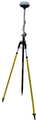
**GPS / GNSS** Hemisphere modelo Atlas Link con suscripción H10 (precisión  $\pm 15$  cm) junto a sus accesorios operativos, tablet y trípode.
